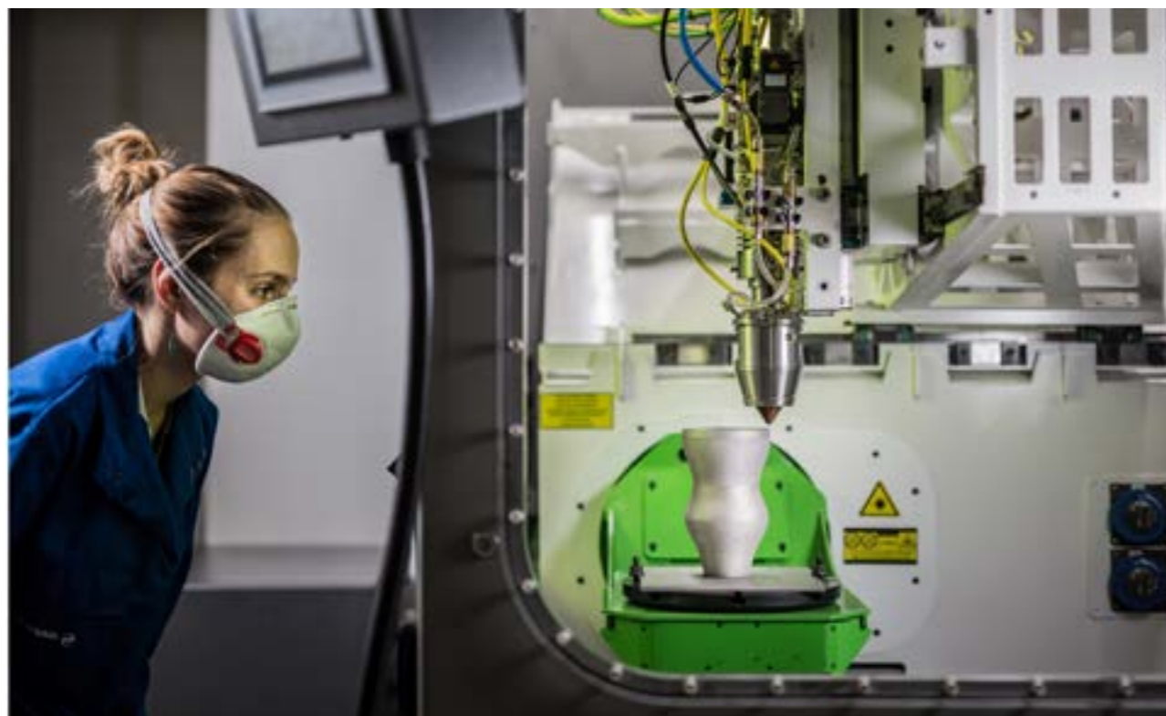
Safran - Fabrication additive déposition métallique par laser-LMD © Adrien Daste/Safran
