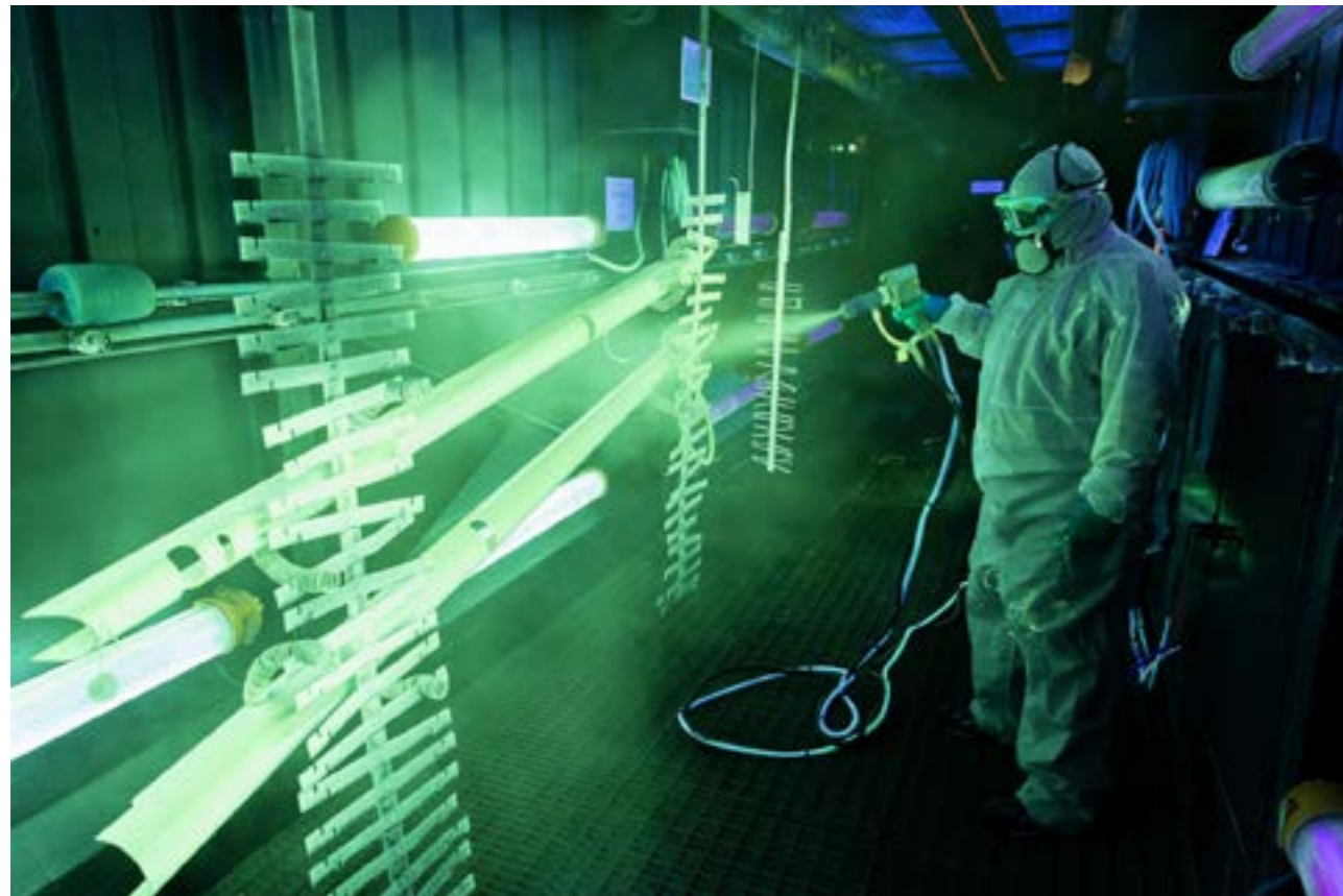
Dassault Aviation - Cabine de ressuage © Dassault Aviation/A.Février
